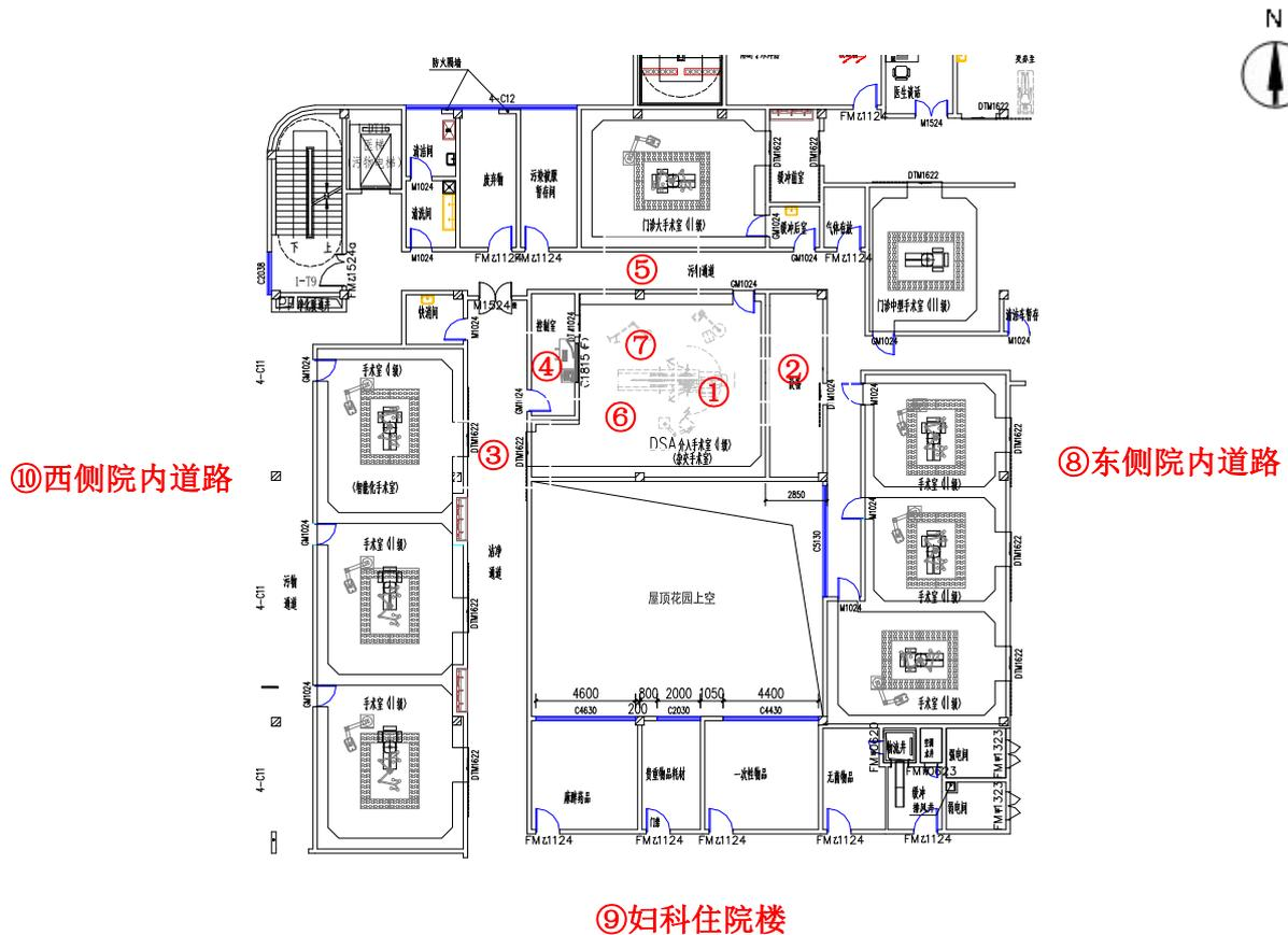
图 8-1 辐射工作场所辐射本底检测点位示意图
